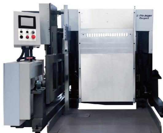
ワンプむき、検品、大裁ち作業に対応する紙積機。
