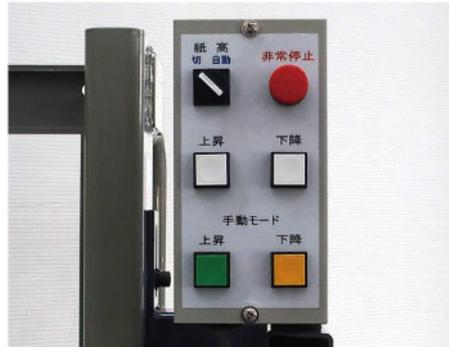
紙検知センサーにより紙の積み替え用リフトとして機能します。紙を取った分だけ、自動的にリフトが上昇し、常に一定の高さで作業可能です。
